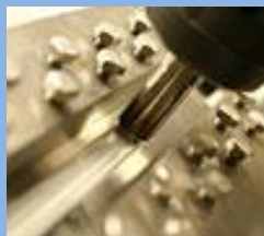
右図は摩擦攪拌接合の様子
