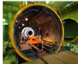
ロケットエンジン高空性能試験設備
