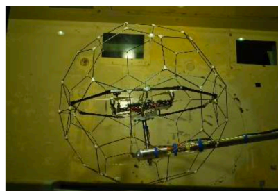
球殻付飛行ロボットの風洞試験
